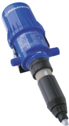
Le modèle Dosatron est un appareil actionné par pression d'eau qui cesse de fonctionner quand la demande est nulle. Son réglage est très facile. Les mélangeurs Venturi sont beaucoup moins onéreux, mais ils ne sont pas aussi fiables. En outre, les appareils à dosage proportionnel sont les plus économiques à long terme.
