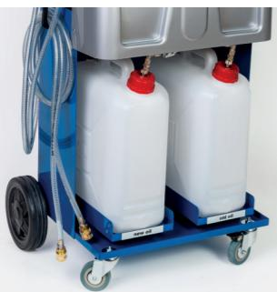
Sistema carrellato per una semplice operatività all'interno dell'officina. È dotato di 2 taniche removibili, destinate al contenimento dell'olio nuovo e a quello esausto. Il tutto è controllato da un sistema di pescaggio e pompaggio che permette lo svuotamento ed il successivo reintegro.
