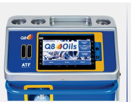
Sistema polifunzionale per la manutenzione delle trasmissioni automatiche con banca dati integrata gestita tramite tablet touch screen da 10,1" per l'esecuzione ed il controllo delle singole fasi di lavoro. È disponibile anche nella versione con scheda elettronica.
